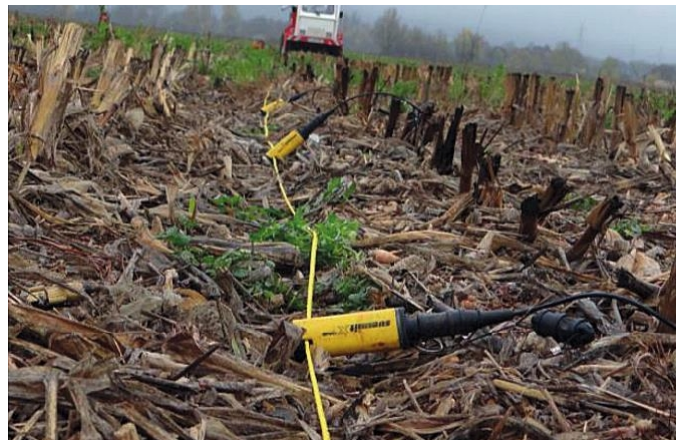
Wdrożenie w terenie do badań wibro-sejsmicznych o wysokiej rozdzielczości
