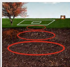
Zanikające pole magnetyczne wytwarza prądy elektryczne w ziemi.
